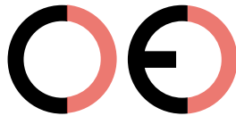
Falsche CE-Kennzeichnung (zu großer Zwischenraum)
